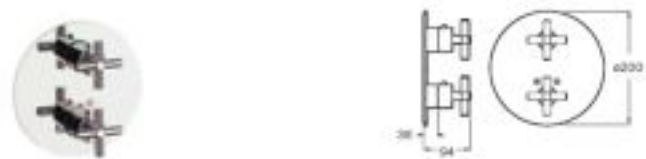
Grifería termostática empotrable para baño-ducha Con desviador-regulador de caudal Cromado A5A0643C00 € 796,00 Según tipo de instalación deberá colocarse una llave de paso
